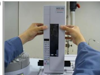
Colocar nuevamente el Inyector AOC 20i/20i Plus evitando la manipulación inadecuada de la bandeja de solventes de manera a proteger el sensor que se encuentra dentro.
