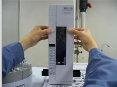
Retirar el Inyector AOC 20i/20i Plus con precaución.
