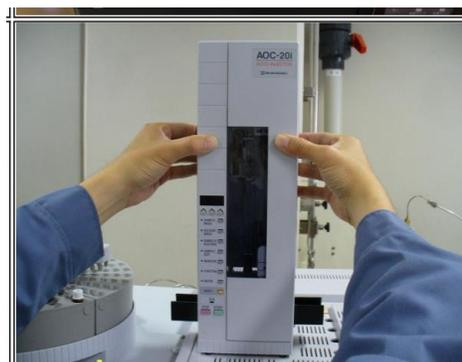
Colocar nuevamente el Inyector AOC 20i/20i Plus evitando la manipulación inadecuada de la bandeja de solventes de manera a proteger el sensor que se encuentra dentro.
