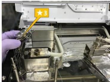
Levantar el puerto de inyección lentamente.
