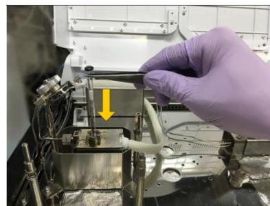
Colocar el inserto de vidrio (227-35008-01) con la junta tórica unido al puerto de inyección y presionar hacia abajo hasta hacer contacto con el fondo.
