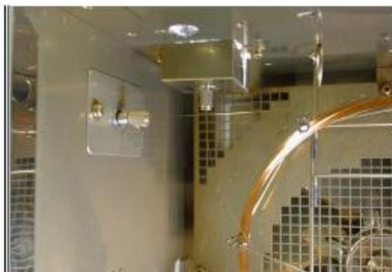
Insertar nuevamente la columna a la boca de inyección con ayuda de la llave correspondiente y evitar que la columna se apoye a las paredes del horno.
