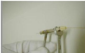
Introducir la sección sobresaliente de la columna a un equipo de fijación y luego ajustar con la llave correspondiente hasta inmovilizar la columna.
