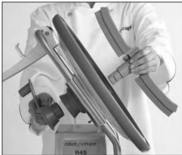
**1.5.2.7. • MONTAJE DEL BRAZO RASCADOR – BLIXER® SOLAMENTE** Sujetar el brazo rascador con una mano y el asa con la otra. Presionar las dos piezas una sobre otra en el centro de la tapa y hacer girar 45 ° el asa en el sentido de las agujas del reloj.
