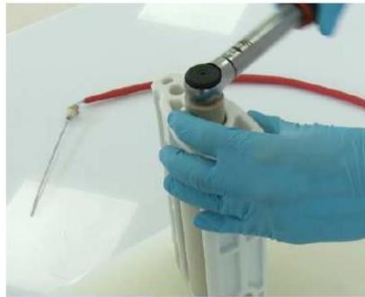
5.1.5 Conecte el sensor de Temperatura
