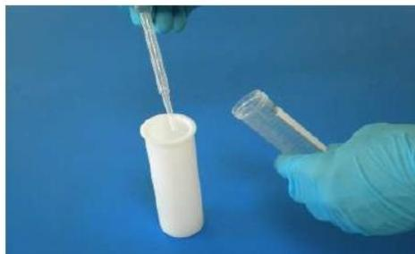
5.1.3 Introduzca los vasos en los protectores HTC. A continuación, coloque en los segmentos del rotor.
